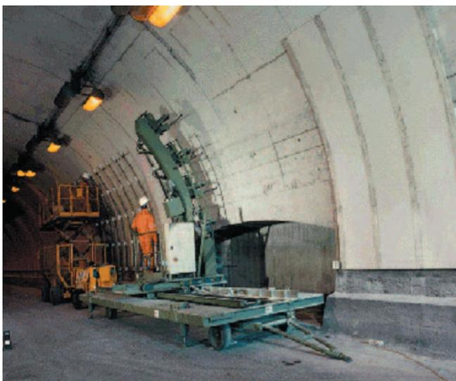
fatica di materiali fragili: in figura un esempio di test che simula le reali condizioni di lavoro del pannello.
