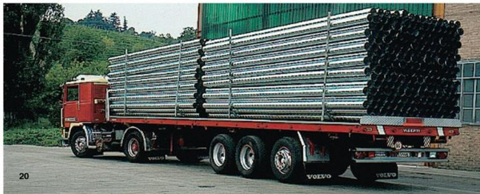
Foto 20 Schema di carico tubazioni elicoidali
