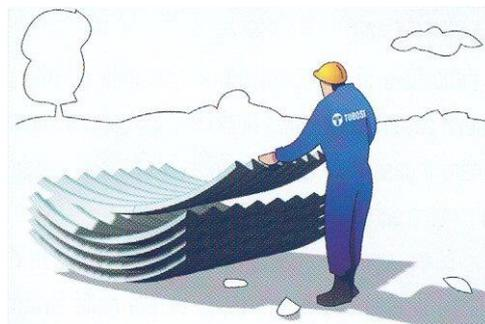
L'avvicinamento al luogo d'installazione deve essere eseguito razionalmente, predisponendo le lamiere in modo tale da subire minori spostamenti e trascinalamenti possibili onde evitare che si possa danneggiare lo stato di protezione dell'acciaio costituito da zinco, o protezioni supplementari.
