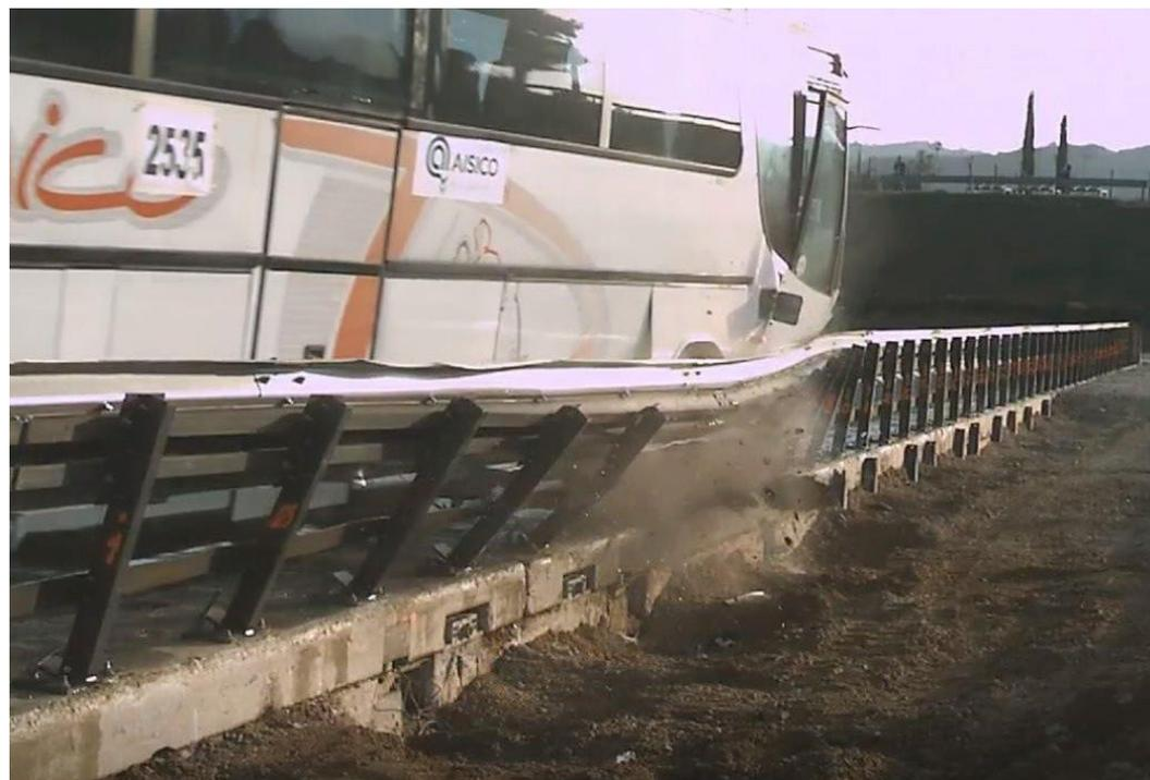
Il graduale collasso della piastra di base, causato dal sistema dissipativo, determina un significativo assorbimento di energia, che ha un impatto benefico sui tasselli di ancoraggio e sulla fondazione. La fondazione può essere dimensionata per carichi notevolmente inferiori ai livelli indicati nella norma EN1991-2 per la forza orizzontale trasmessa dal sistema di ritenuta.
